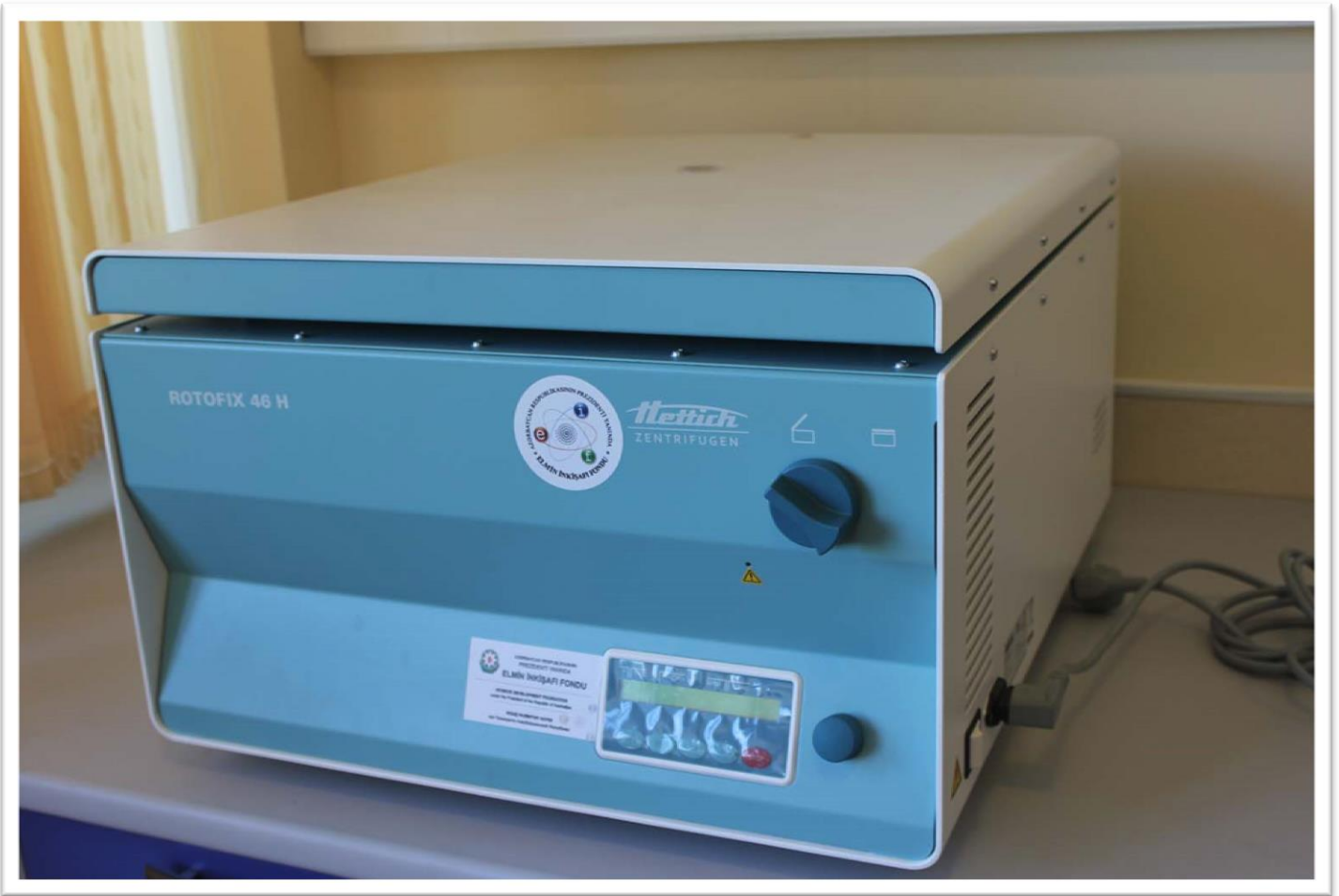
PETROLEUM CENTRIFUGE ROTOFIX. Sürtkülərdə mexaniki qarışıqları təyin edən cihaz, ASTM D2273 üzrə.
