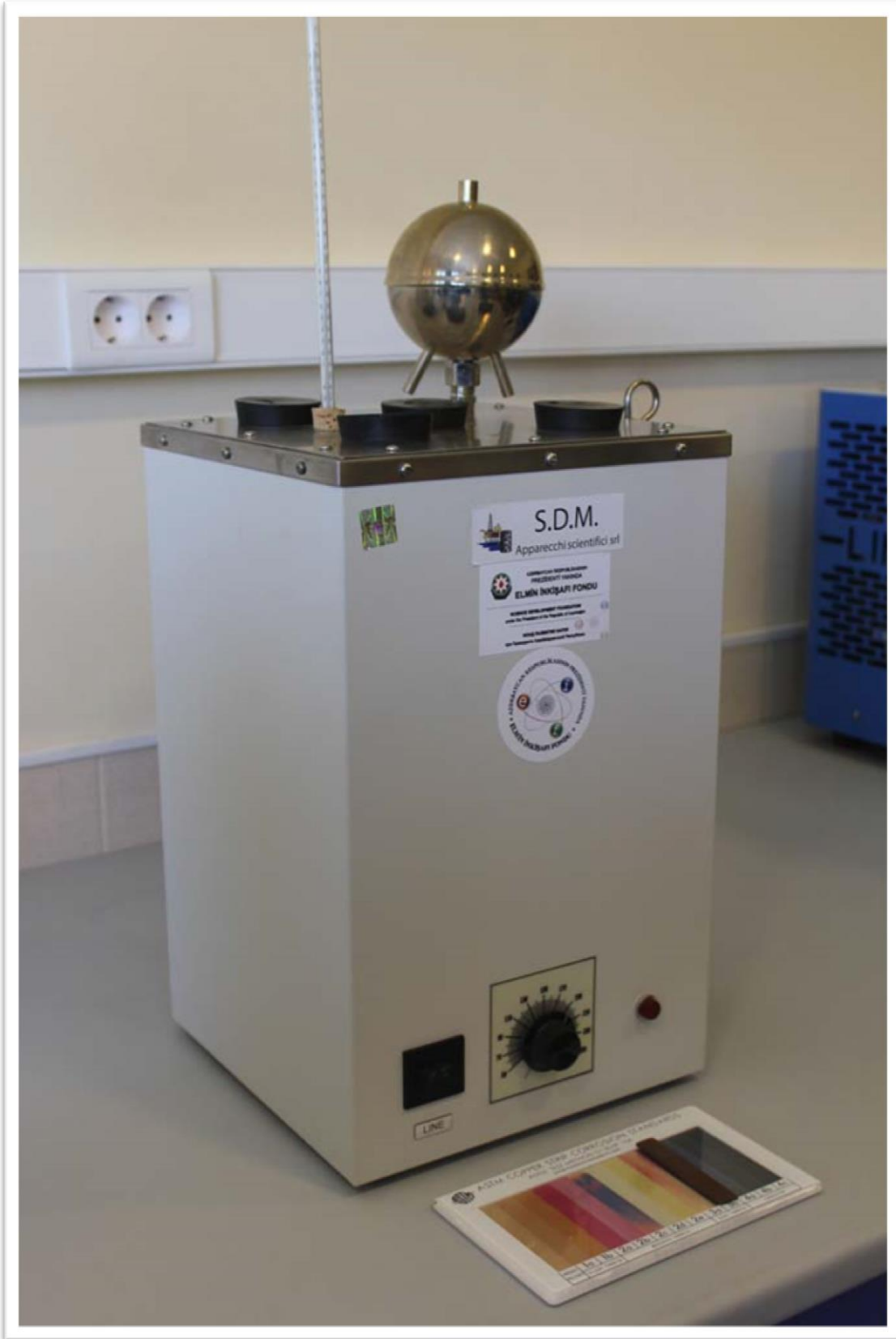
COPPER/SILVER CORROSION BATH. Lenta üsulu ilə korroziyanı təyin edən cihaz, ASTM D130 üzrə.
