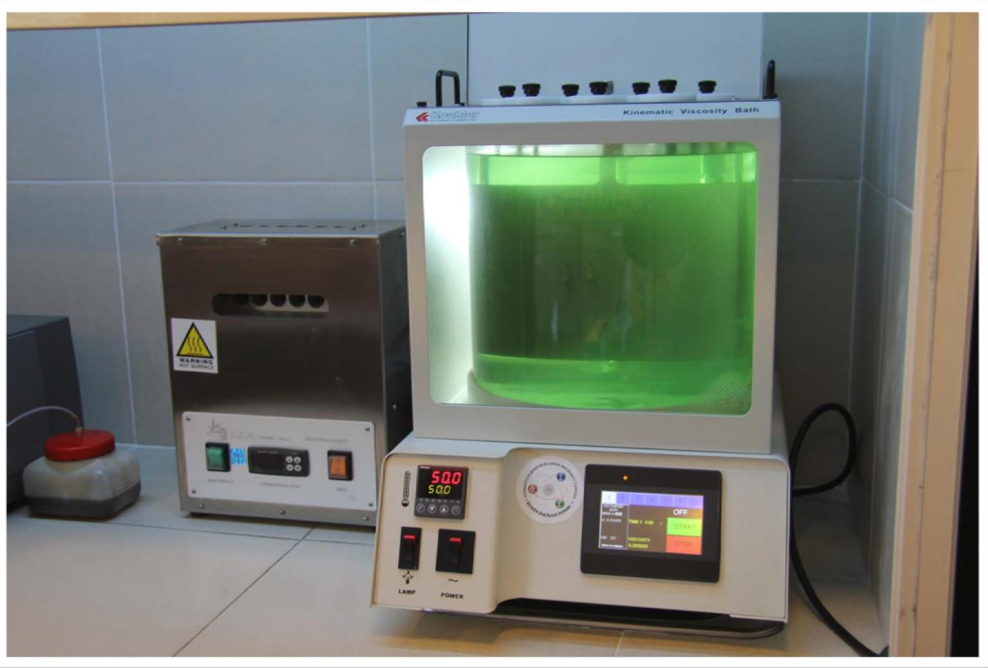
SEMI-AUTOMATIC VISCOSITY BATH, KOEHLER KV4000 K23792. Yağların kinematik özlülüyünü təyin edən cihaz, ASTM D445, D446 üzrə.
