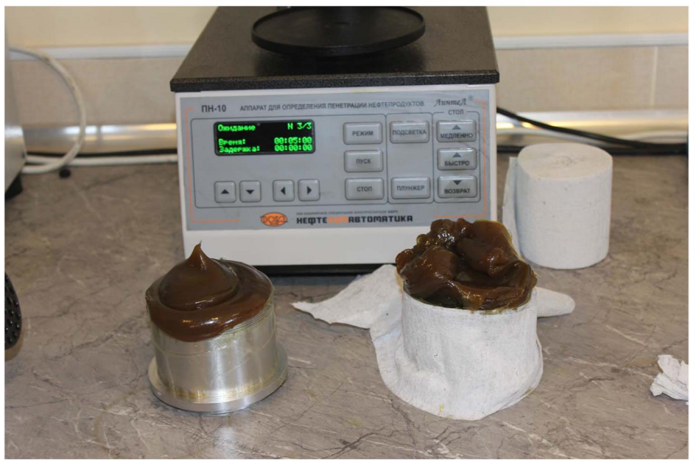
Линтел(ПН-10С). Sürtkülərin penetrasiyasını (yumşaqlığını) təyin edən cihaz ASTM D217 üzrə.
