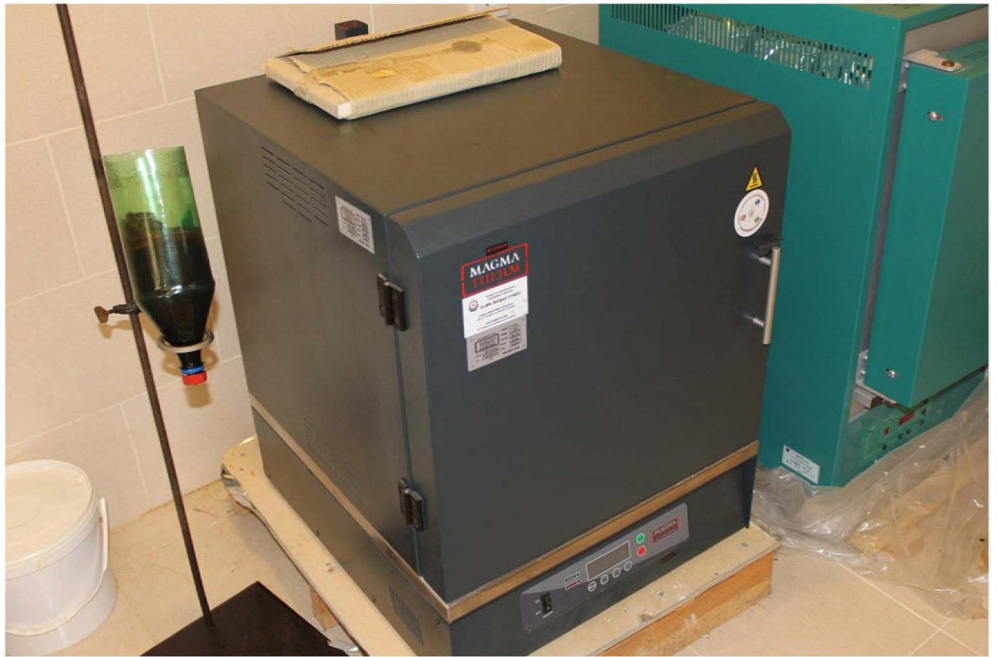
GMATHERM MT1110 ASH DETERMINATION. Kül qalığını təyin edən cihaz, ASTM D482 üzrə.
