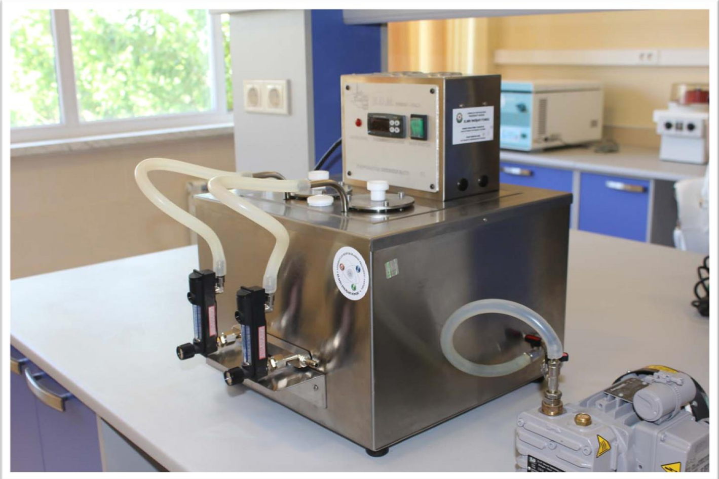
EVAPORATION GREASES BATH 2050. Sürtkülərin buxarlanmasını təyin edən cihaz, ASTM E1721 üzrə.
