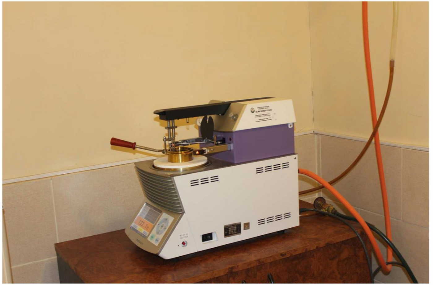
Automated Cleveland Open Cup Flash Point Tester/ ACO-8. Yağların açıq putada alışma temperaturunu təyin edən cihaz, ASTM D92 üzrə.
