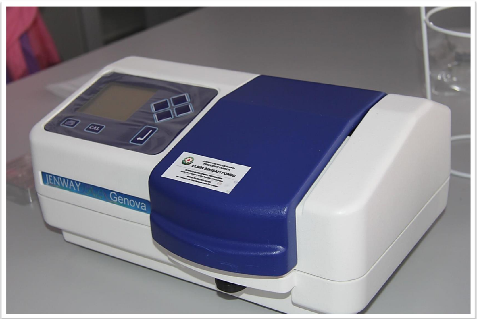
JENWAY-Genova - spektrofotometr- DNT, RNT və zülalların, piqmentlərin və fermentlərin miqdarının və aktivliklərinin təyinində istifadə olunur
