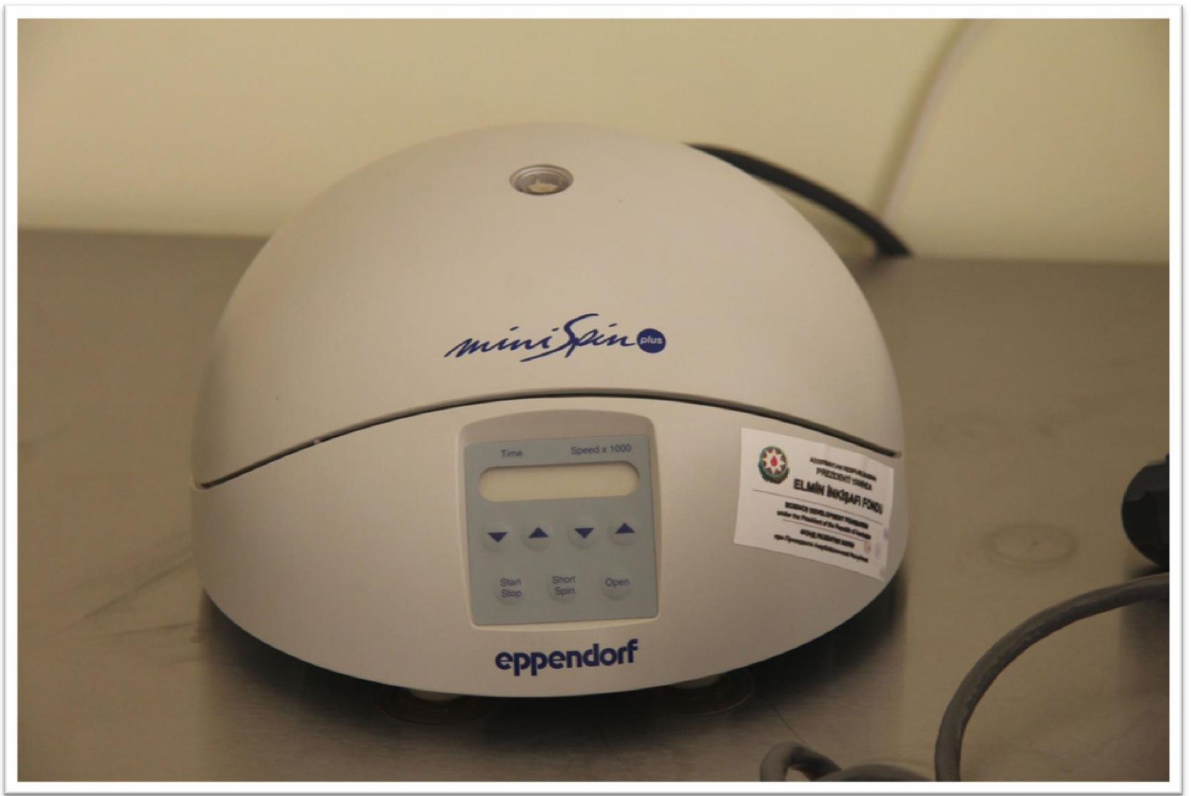
Mini Spin – sentrifuga-kıçık h cmlı tyubları fırlatmaq  c n istifadə olunur.
